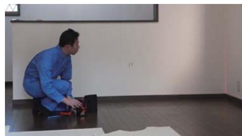
専門の機器を用いて建物の傾きを調査します。
